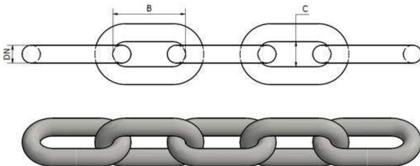
CHAÎNE POUR AMARRAGE, en 3 qualités standard de SL1 en acier ordinaire à SL3 en acier allié au manganèse haute résistance (din 17115), l'intérieur avec permet de s'adapter dans des manilles, sans maillons d'extrémité spéciaux.
